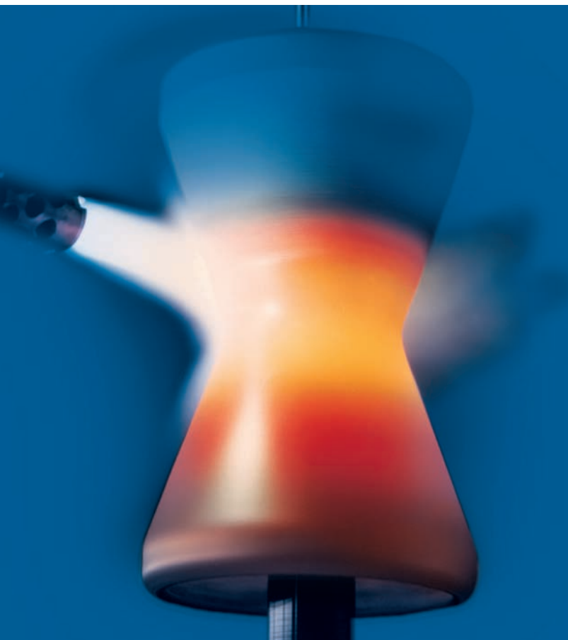
Automatisk fiksering av CrNiBoSi-legering sprøytet på tauverk ved hjelp av pulversprøyting.
